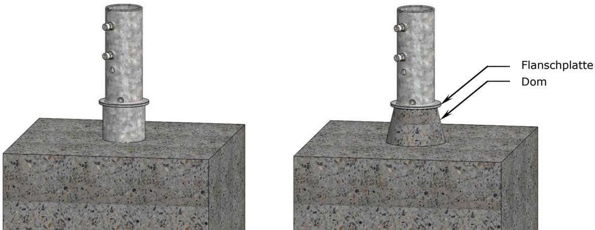
7. Damit die Abdeckscheibe (bei Abnahme der Ankerhülse) ebenerdig abschließt (vgl. Abbildung b), drücken Sie die Bodenhülse 4 mm tiefer als die Terrassen-Oberfläche in den Beton ein (vgl. Abbildung a: für eine deutlichere Darstellung wurde die Ankerhülse in der Zeichnung ausgeblendet). Somit vermeiden Sie eine Stolperfalle.
