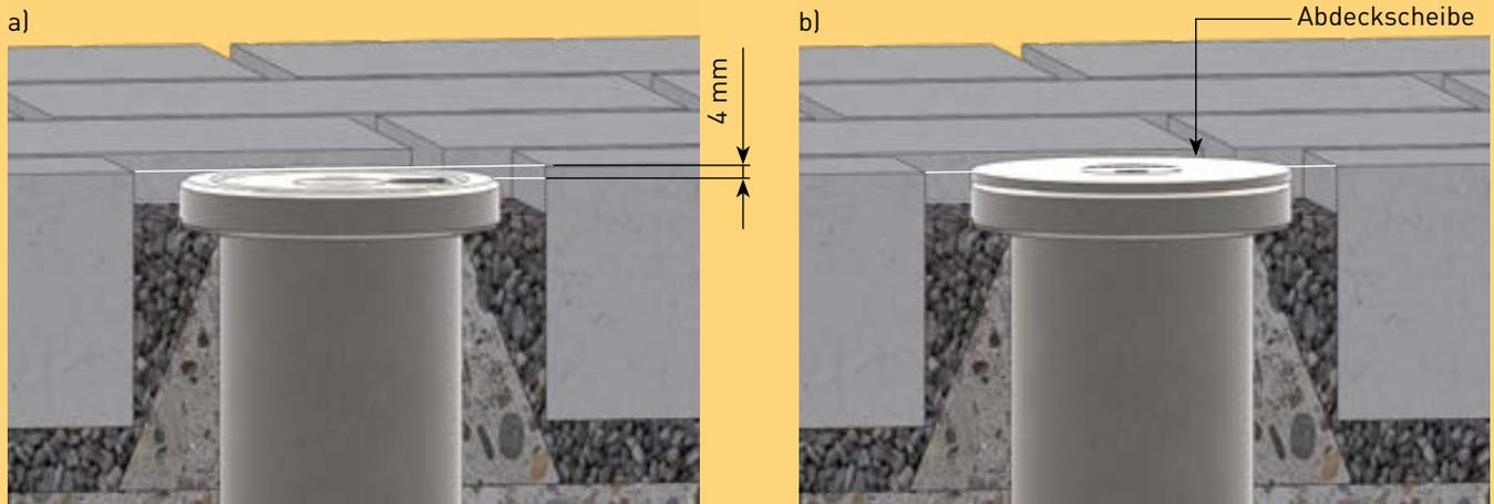
8. Richten Sie das Ankerhülsen-Oberteil mittels Wasserwaage aus (vgl. Abbildung).
