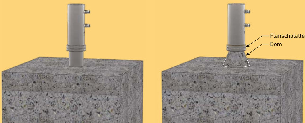
7. Damit die Abdeckscheibe (bei Abnahme des Ankerhülsen-Oberteils) ebenerdig abschließt (vgl. Abbildung b), drücken Sie das Ankerhülsen-Unterteil 4 mm tiefer als die Terrassen-Oberfläche in den Beton ein (vgl. Abbildung a: für eine deutlichere Darstellung wurde das Oberteil in der Zeichnung ausgeblendet). Somit vermeiden Sie eine Stolperfalle.
