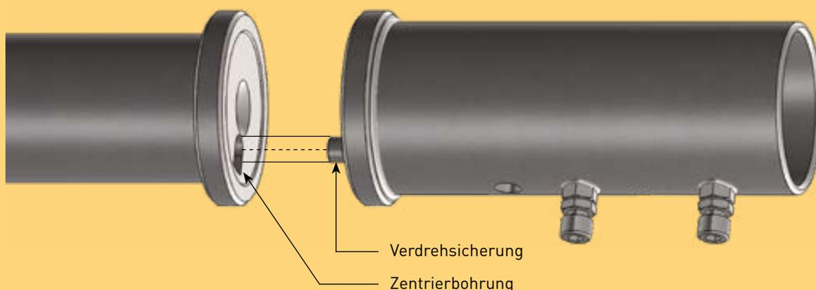
5. Das kleine Spiel in der Verdrehsicherung verhindert eine eindeutige Ausrichtung der Schirme, parallel zur Hauswand, nach einer Demontage. Drehen Sie daher das Oberteil im Uhrzeigersinn bis zum Anschlag, damit die Schirme auch nach einer erneuten Montage des Oberteils wieder gleich stehen.
