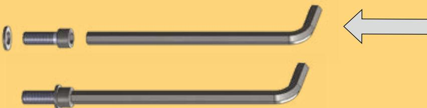
3. Stecken Sie diese Einheit durch die stirnseitige Durchgangsbohrung des Ankerhülsen-Oberteils.
