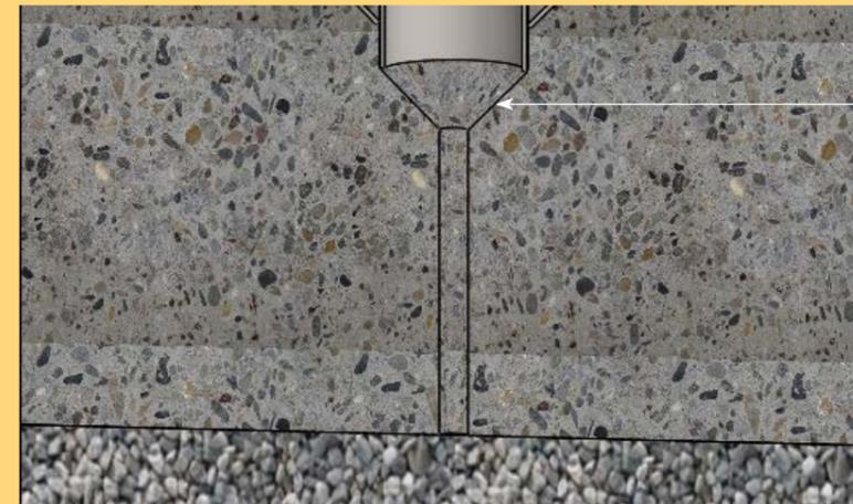
Aussparung oder Drainagerohr anbringen, z.B. PE 56
