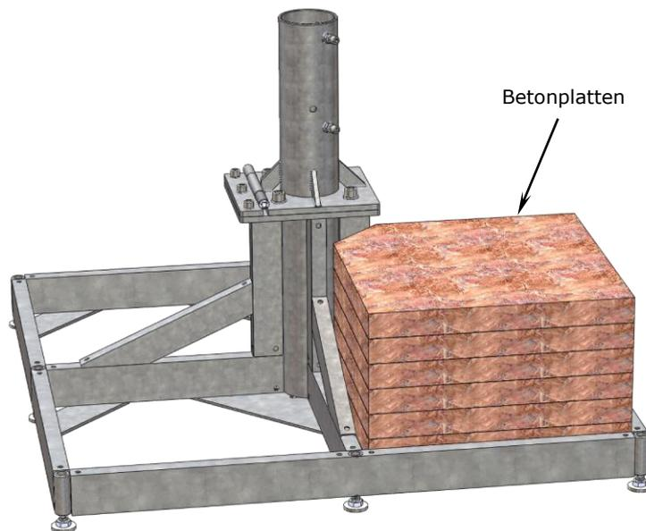
8. Damit die Betonplatten eingelegt werden können, muss jeweils eine Ecke 70 mm x 45° abgeschnitten werden.
