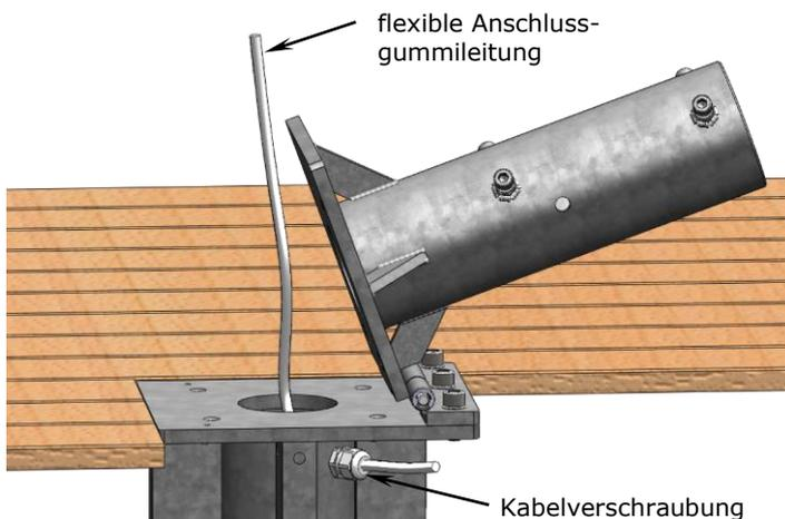
2. Verbinden Sie die Anschlussgummileitung und die Stromversorgung für den Sonnenschirm wasserdicht. Die Anschlussgummileitung (bei Starkstrom: min. 5-polig, min. 4mm<sup>2</sup> Leitungsquerschnitt) muss passend zu Verbrauchern und Zuleitungslänge von einem Elektrofachmann ausgelegt werden.
