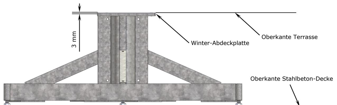
6. Im Normalfall ist die Stahlbeton-Decke nicht horizontal, folglich würde der Schirm später nicht vertikal stehen.
