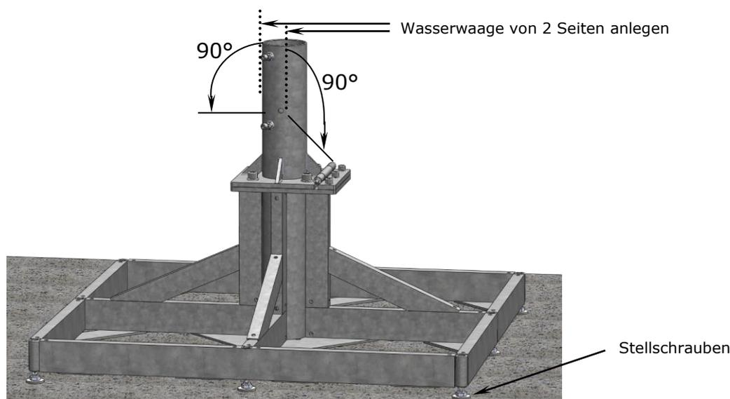
7. Bestücken Sie den Grundrahmen mit Betonplatten. Bei handelsüblichen Betonplatten mit 50x50x5 cm und 28 kg Einzelgewicht richten Sie sich nach folgender Tabelle:
