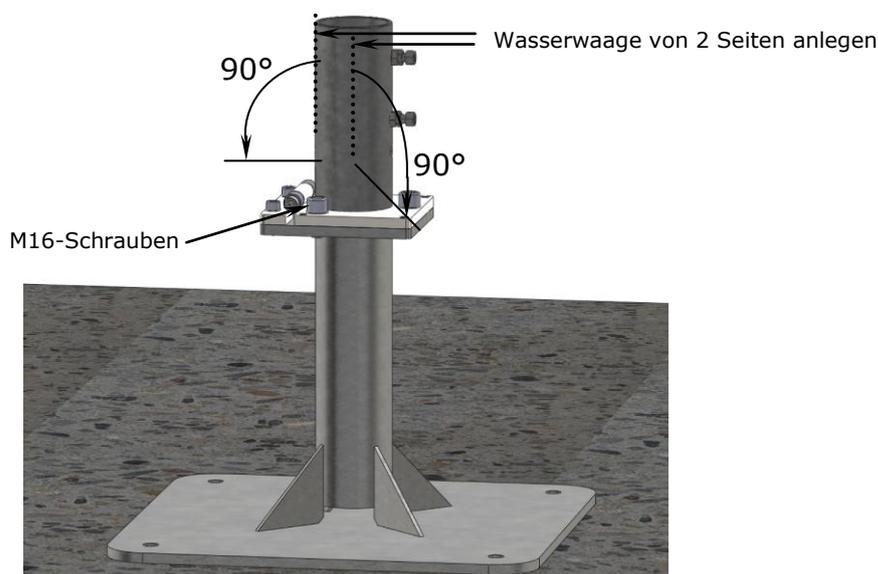
4. Richten Sie die SZ127 / SZ027 so aus, dass die Grundplatte des Unterteils korrekt mit der Oberkante des Terrassenbodens abschließt.
