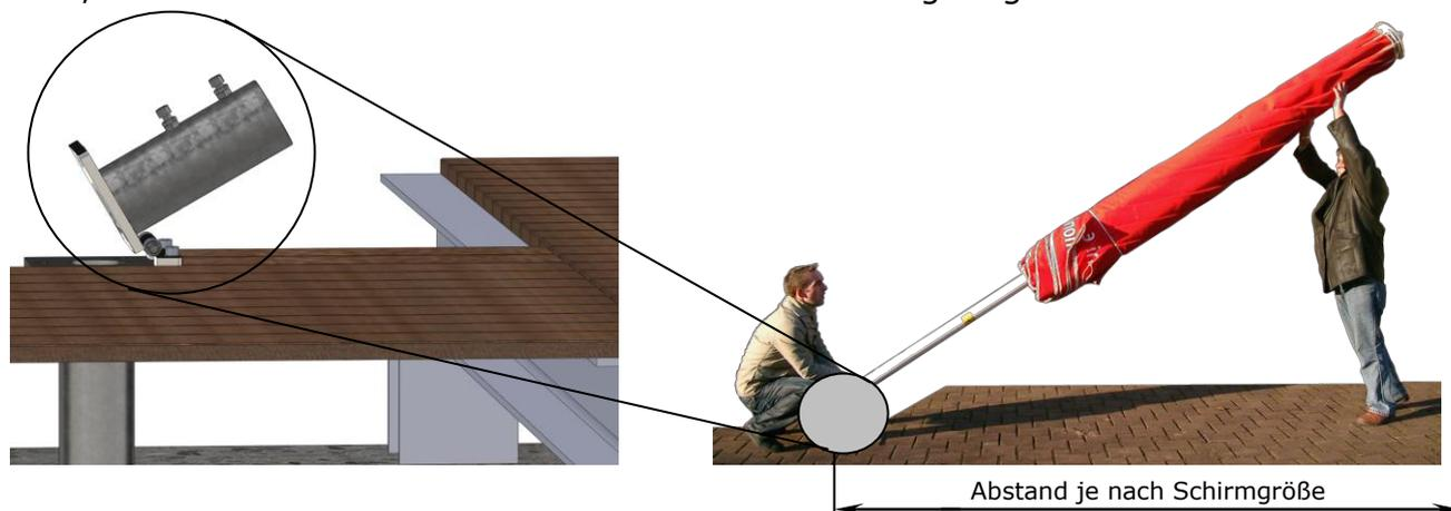
2. Positionieren Sie die SZ127 / SZ027 durch genaues Ausmessen der Schirmachse. Halten Sie einen Sicherheitsabstand zwischen den Schirmen / Hauswand.
