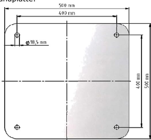
Bohrungen für Schwerlastanker nicht ohne Grundplatte an Baustelle bohren. Es sind insgesamt 4 Schwerlastanker notwendig. Erhältlich unter der Artikelnummer 200900, in Edelstahl A4.
